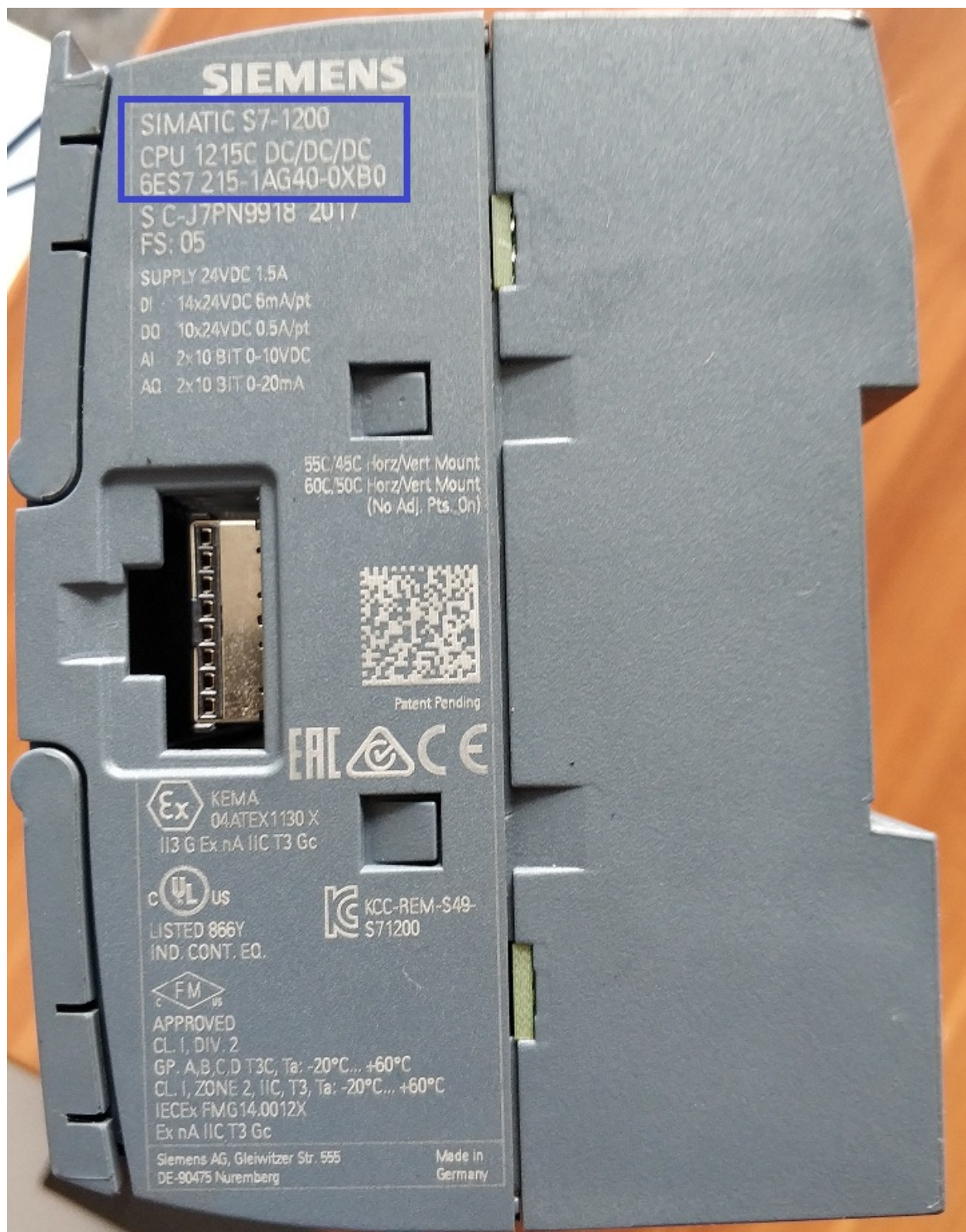
Fig. 2: CPU 1215C DC/DC/DC 6ES7 215-1AG40-0XB0
